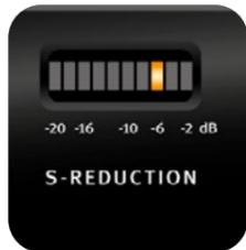
Die S-Reduction-LED-Anzeige, visualisiert die Intensität der S-Laut-Reduzierung zwischen 0 dB und -20 dB in 2 dB-Schritten.
