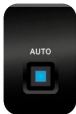
Der Auto-Schalter aktiviert die Auto-Dynamic-Funktion. Diese regelt den Schwellwert (=Threshold) beziehungsweise den Einsatzpunkt automatisch nach, wenn die Eingangsamplitude durch Veränderung der Sprechposition zum Mikrofon schwankt.
