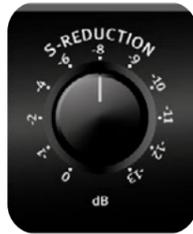
Mit dem Regler S-Reduction wird die Intensität der S-Laut-Reduzierung eingestellt.
