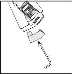
3. 使用XLR/Boompole适配器，使用拧紧螺丝固定式XLR电缆代替3mm六角扳手。
