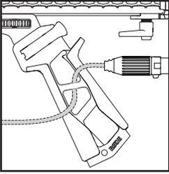
1. 通过手柄组件插入电缆，使电线路由，如图所示。
