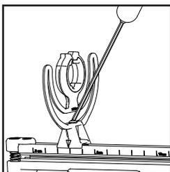
3. 确保Lyre剪辑中心，坐在直上轨向上和向下，重新拧紧夹紧螺丝。
