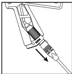
1. 要删除已安装的Blimp临线，先拔掉当前连接任何电缆。
