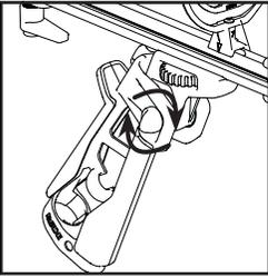
2. 拧紧手柄的右侧的角钳张力螺丝以增加快速释放夹具的张力。
