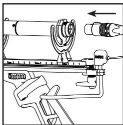
5. 插头的Blimp临线到你的麦克风的XLR插孔。
