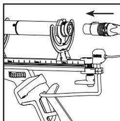
6. 将电缆连接到麦克风和调整手柄使用所需的角度的。
