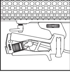
由于RØDE Blimp附带手柄倒塌，一个松散的角度钳设置，您将需要按照下面的说明来调整手柄角度设置的实力。
