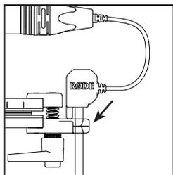
5. 如果使用Blimp临线，采用电缆护环在轨道的后部固定电缆到位，确保该取向中所示的图像相匹配。
