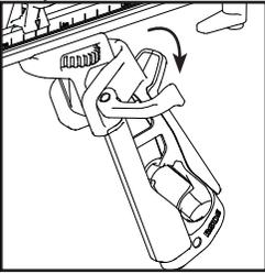
1. 打开“快速释放”的角度钳手柄的左侧和手柄移动到所需角度。
