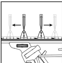
2. 抱着Lyre夹和导轨的基础上，轻轻的Lyre夹滑动到所需的位置。
