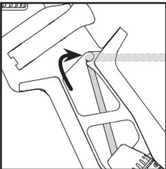
4. 使用电缆管理夹在手柄的顶部固定电缆。
